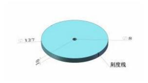
图 4 顶部砝码盘及附属配件(单位: mm)
