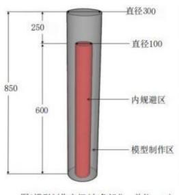
图2模型制作空间(灰色部分,单位: mm)
