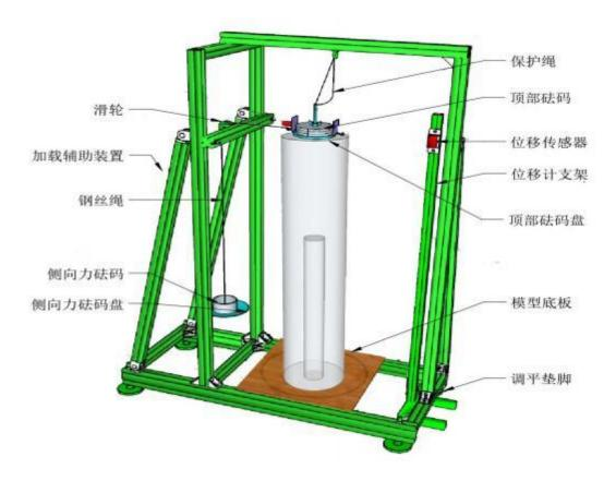
图 1 模型及加载装置示意图
